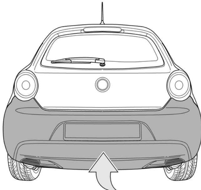
**D** Der Freiraum nach Anhang VII, Abbildung 30 der Richtlinie 94/20/EG ist zu gewährleisten.
