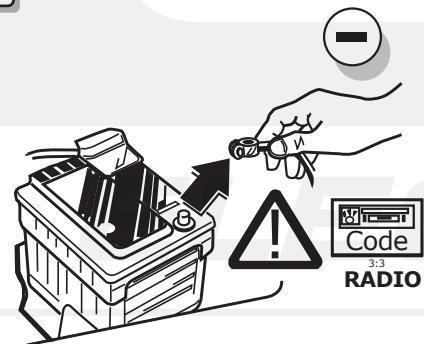
(DE) Um Störungen und Schäden am Bordnetz zu vermeiden, muss die Massepolklemme unbedingt vor Beginn aller Arbeiten von der Fahrzeugbatterie getrennt werden! Insbesondere bei Arbeiten und Anschlüssen am CAN-Datenbus kann bei nicht abgeklemmter Batterie sowohl das Anhängermodul als auch das fahrzeugsseitige Bordnetzsteuergerät beschädigt werden! Bitte Herstellervorschriften beim Ab- und Anklemmen der Fahrzeugbatterie beachten!
