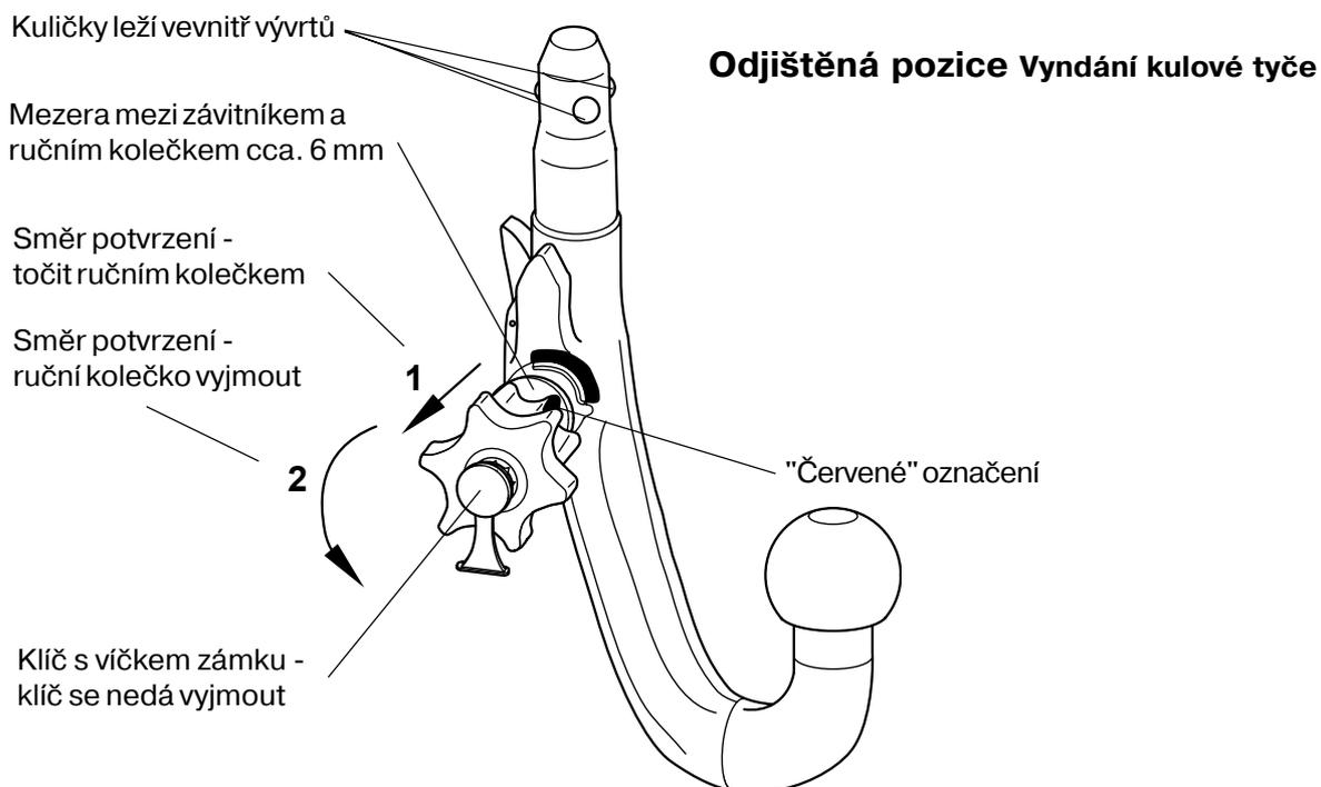
Tilladelsesnummer iflg. retningslinie 94/20/EU: **e13 00-0552**Klasse: **A50-X** Type: **303 137**Tekniske specifikationer: Maksimal D-værdi: **15,5 kN**Maksimal støttelast: **150 kg**
