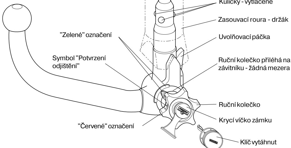
**Odjištěná pozice Vyndání kulové tyče**
